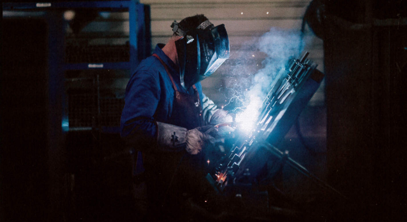
Dans ses ateliers de Feuquières-en-Vimeu, Decayeux consomme 300 tonnes chaque mois d'acier (acier, inox, alu, tubes...). Une fois, pliée, percée et soudée cette matière est assemblée pour être décorée. 180 tonnes de peinture en poudre sont consommées chaque mois.
