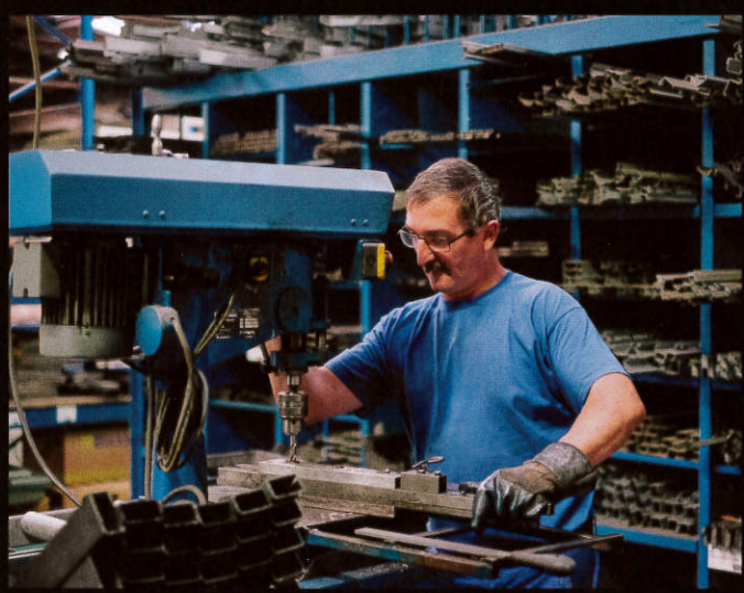
Dans ses ateliers de Feuquières-en-Vimeu, Decayeux consomme 300 tonnes chaque mois d'acier (acier, inox, alu, tubes...). Une fois, pliée, percée et soudée cette matière est assemblée pour être décorée. 180 tonnes de peinture en poudre sont consommées chaque mois.
