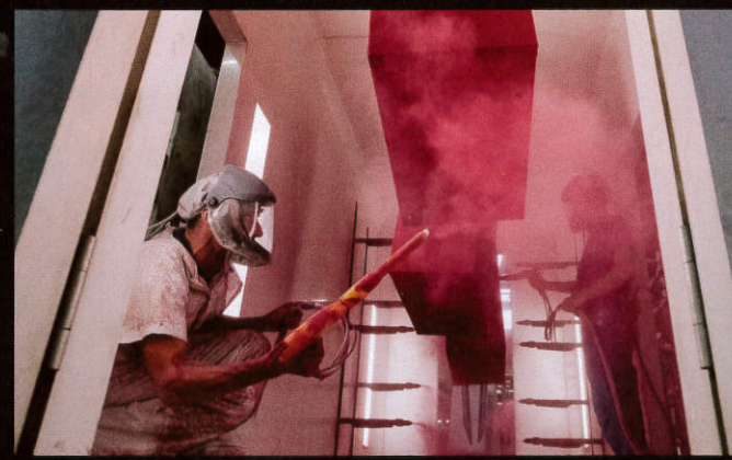
Dans ses ateliers de Feuquières-en-Vimeu, Decayeux consomme 300 tonnes chaque mois d'acier (acier, inox, alu, tubes...). Une fois, pliée, percée et soudée cette matière est assemblée pour être décorée. 180 tonnes de peinture en poudre sont consommées chaque mois.
