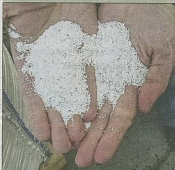
Un appareil de tri optique permet d'obtenir ce gravier très blanc.
